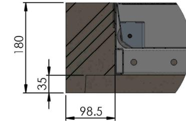
Bis 3cm Betoniert für modularer Schacht
