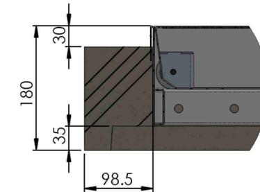
Bis 3cm Betoniert ohne Schacht
